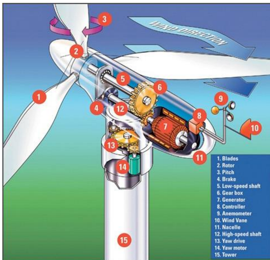
Rycina 3 Schemat budowy turbiny wiatrowej (źródło: http://elektrownie-wiatrowe.pl )
